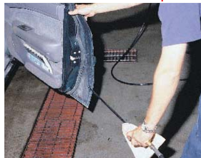
Traitement de l'intérieur d'une portière
